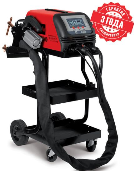
Telwin DIGITAL SPOTTER 7000 400V +ACC сварочный аппарат с микропроцессорным управлением, предназначенный для точечной сварки тонкостенного металла. Применяется в авторемонтных мастерских, производственных площадках. Многофункциональный ЖК-дисплей обеспечивает автоматическое регулирование параметров точечной сварки в зависимости от выбранного инструмента и толщины листа.
