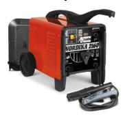
Сварочный аппарат Telwin NORDIKA 2160 предназначен для ручной дуговой сварки покрытым металлическим электродом на переменном токе (AC). Непрерывное регулирование тока сварки. Термостатическая защита. Используемые электроды: рутиловые. В комплектацию входят принадлежности для сварки ММА.
