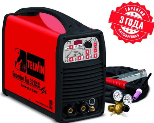
Сварочный аппарат SUPERIOR TIG 322 AC/DC HF/LIFT 400VACC – предназначен для аргоно-дуговой сварки TIG, PULSE TIG с бесконтактным HF и контактным LIFT поджигом дуги на переменном AC и постоянном токе DC и ручной дуговой сварки MMA. Аппарат применяют для сварки различных материалов, таких как: сталь, нержавеющая сталь, алюминий, титан, медь, никель и их сплавы. Укомплектован принадлежностями для сварки TIG.
