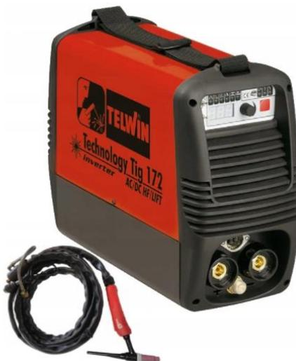
Инверторный сварочный выпрямитель для сварки TIG переменным (AC) и постоянным (DC) током с бесконтактным или сенсорным (LIFT) зажиганием дуги и методом MMA с покрытым электродом на постоянном токе (DC).
